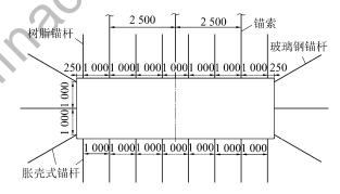
图 3 开切眼支护设计断面
