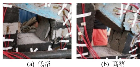
图10 物理试验巷道的变形破坏
