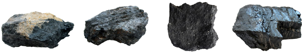
(a) TS7块状焦 (b) TS8砾状焦 (c) XY3粒状焦 (d) TS12正常煤
