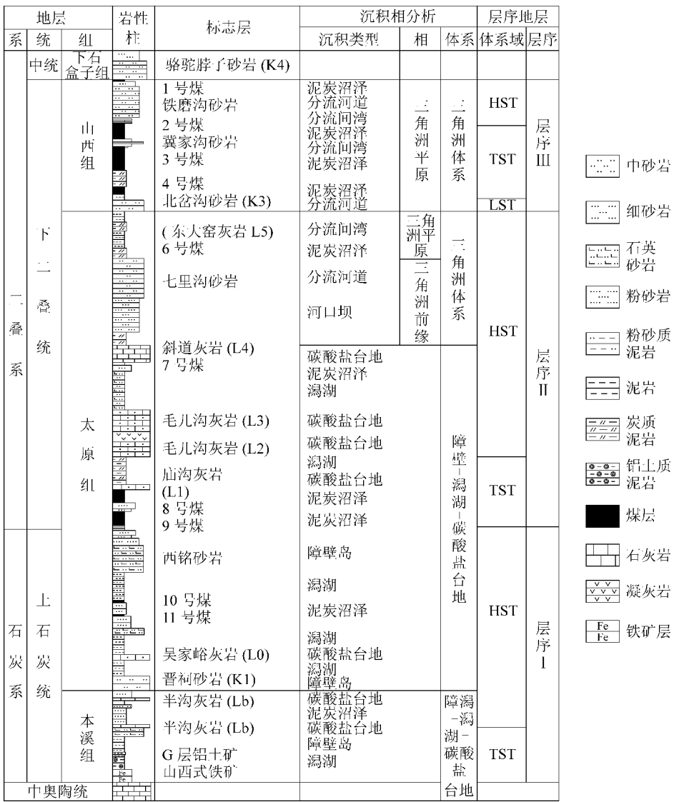
图2 山西省西山煤田石炭-二叠纪含煤岩系沉积相及层序地层柱状
