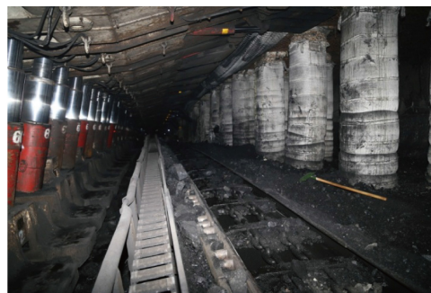
(a) 泵充混凝土支柱支护
