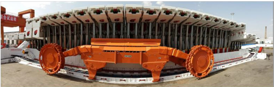
图 5 8.2 m 超大采高综采技术及成套装备
