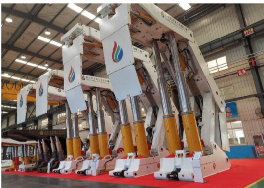
图 27 ZFY21000/35.5/70D 型两柱掩护式放顶煤液压支架
