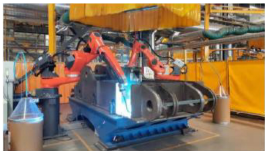
图 22 机器人焊接掩护梁
