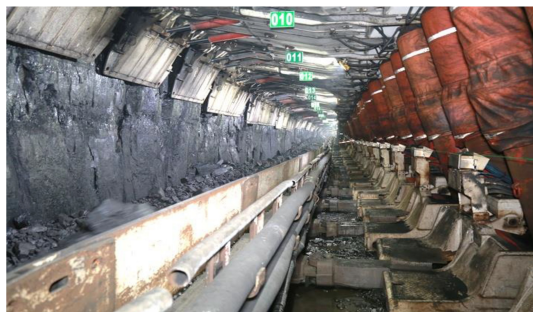
图14 中厚煤层年产千万吨智能开采工作面
