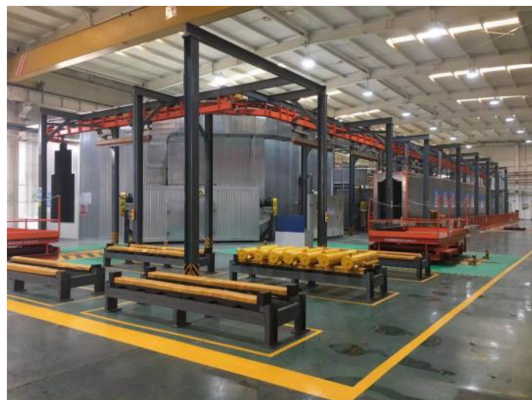
图 21 油缸喷粉生产线
