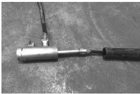
图 4 气举管与封孔管安装关系
