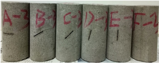
图1 标准圆柱形类岩石试件
