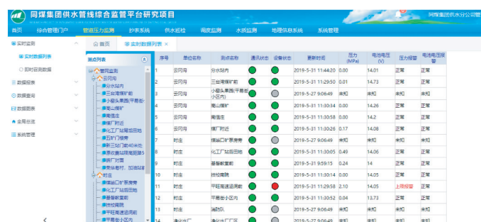
(c) 管道压力监测预警系统
