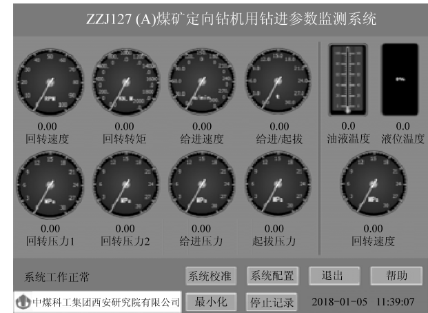
图5 钻进参数监测系统运行主界面
