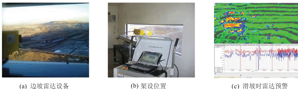
图9 滑坡雷达监测预警系统
