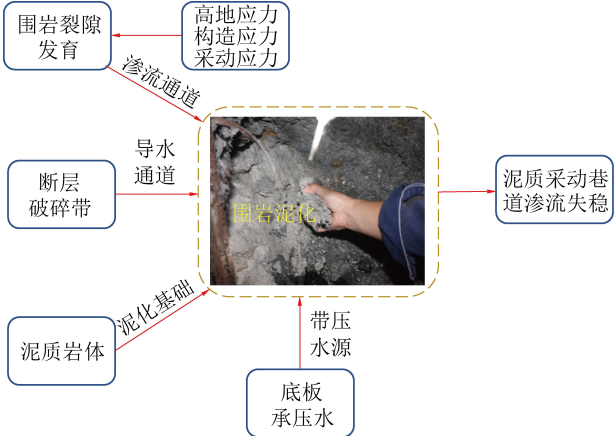
图 22 泥质软岩巷道渗流失稳过程 [89]
