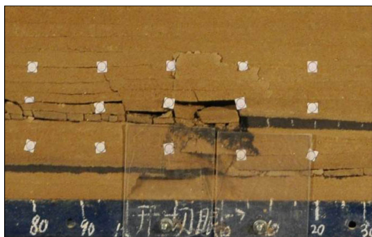
图 7 上行式开采三铰拱式结构失稳(推采至开切眼上方)
