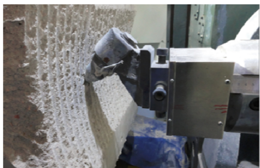
图 1 截割刀具试验平台
