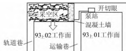
图 5 泵站位置及充填线路布置方案
