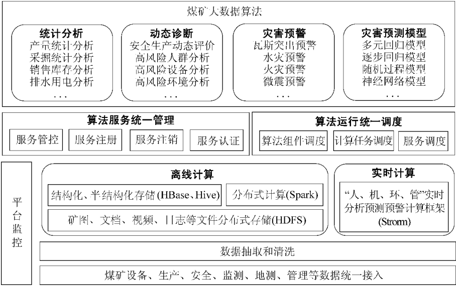
图 2 煤矿安全生产大数据分析平台技术框架
