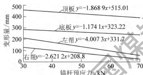
图 1 锚杆预应力作用下巷道各部位变形
