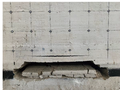
图 11 煤层开挖至 50 m 处覆岩初次垮落
