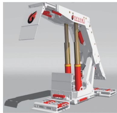
图 4 ZFY21000/35.5/70D 型超大采高综放液压支架
