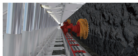
图 8 采煤机智能截割显示界面
