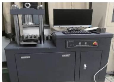
图 6 YAW-150 型微机控制电液伺服压力试验机
