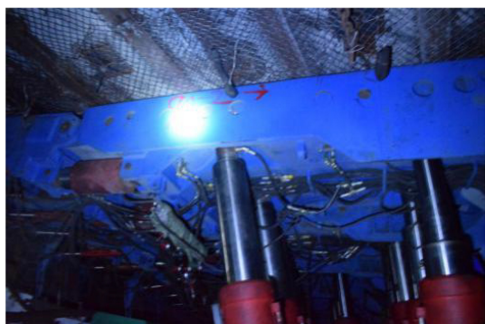
图8 “金属网+工字钢”管理破碎顶板
