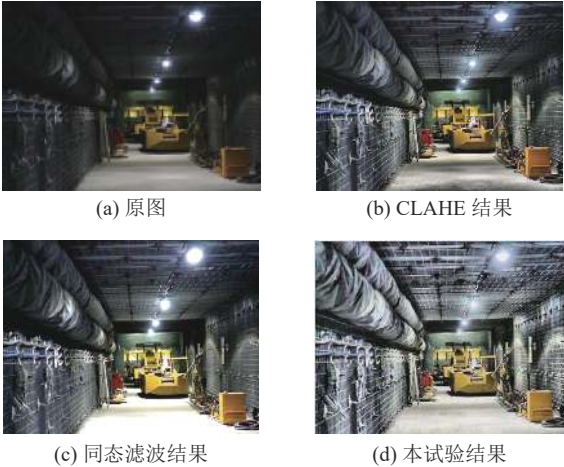
图 8 巷道图像的试验结果 Fig.8 Experimental results of roadway images
