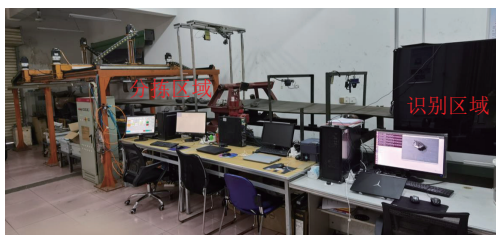
图 6 双机械臂煤矸石分拣机器人试验平台
