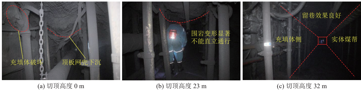
图 17 不同切顶高度现场试验效果
