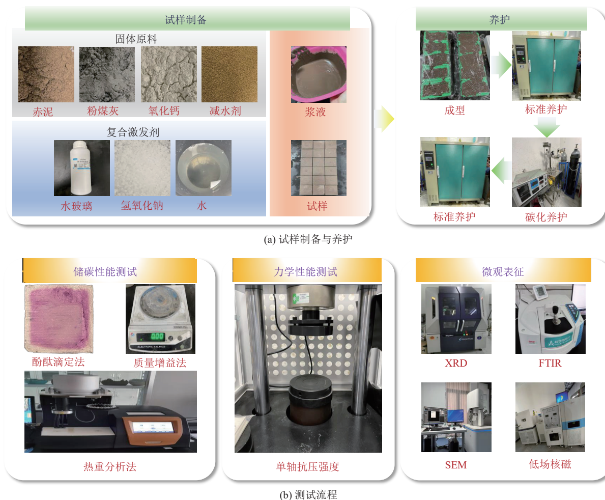
图 2 试样制备及测试流程
