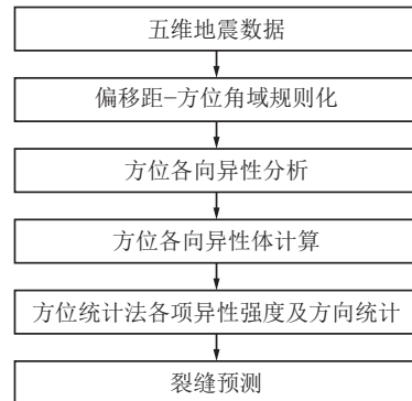
图 3 五维地震数据裂缝预测技术流程
