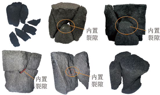
图 19 单裂隙试样破坏模式
