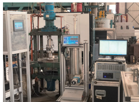
图 2 高围压大位移实时剪切-渗流装置及声发射系统
