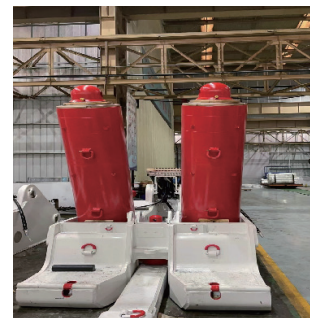
(c) 抗冲立柱现场装配图
