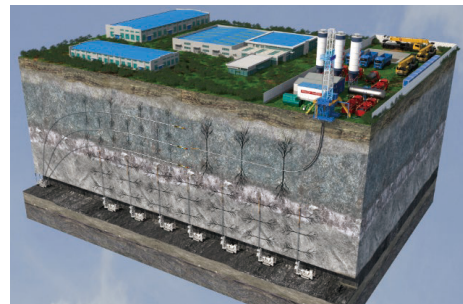
图 13 井上下顶板区域压裂防冲示意
