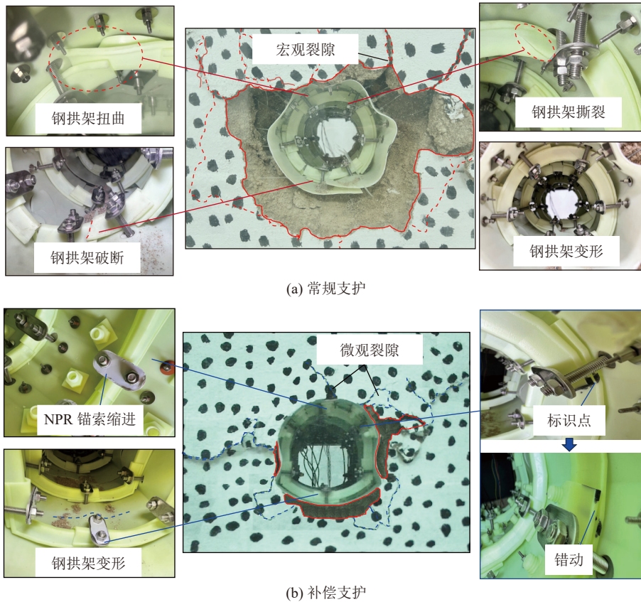
图 17 不同支护模式围岩及支护变形
