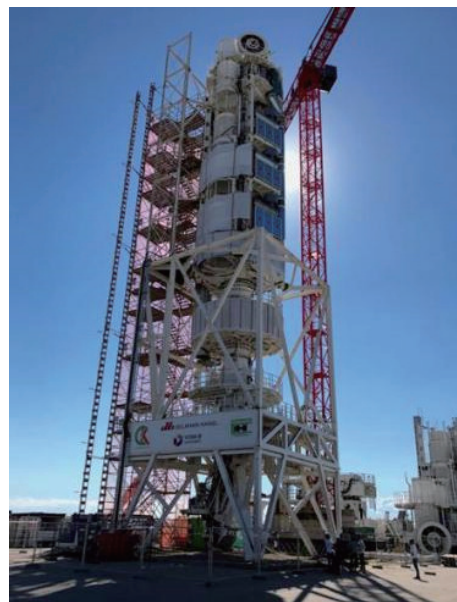
图8 Nezinsky 钾盐矿 SBR 竖井掘进机
