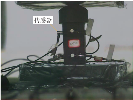
图 2 AE 传感器布置
