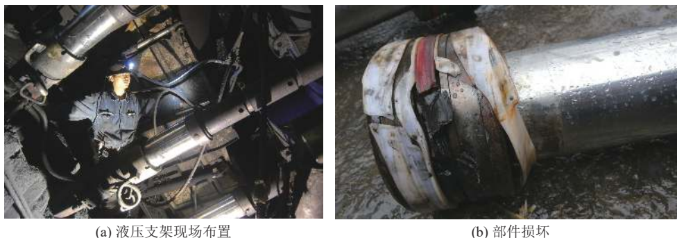
图1 大倾角煤层长壁工作面液压支架工作状态
