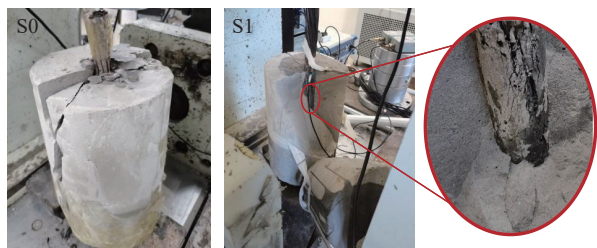
图 20 全长锚固结构拉拔后的破坏特征
