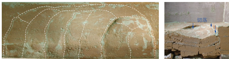
图 10 采动覆岩裂缝空间分布
