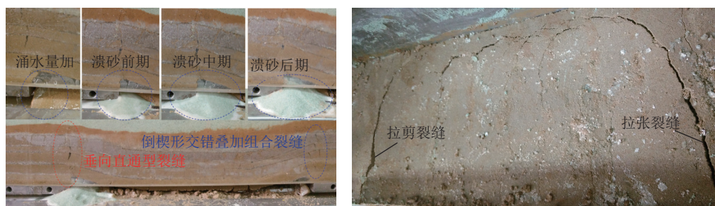
图 12 覆岩采动劣化及突水溃砂特征(方案三)
