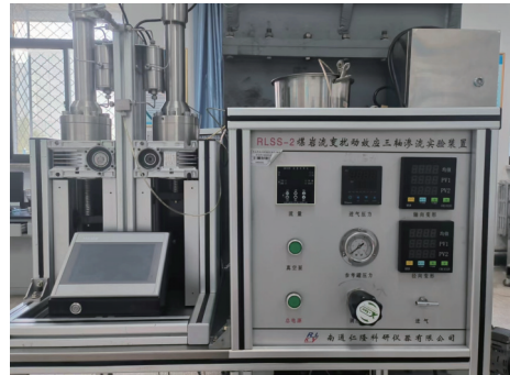
图2 煤岩流变扰动效应渗流实验装置
