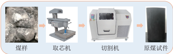
图 1 原煤制作流程
