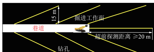
图1 煤巷掘进超前钻探示意
