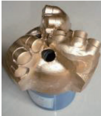
图 19 弧角钻头照片 Fig.19 Photo of arc angle drilling bit
