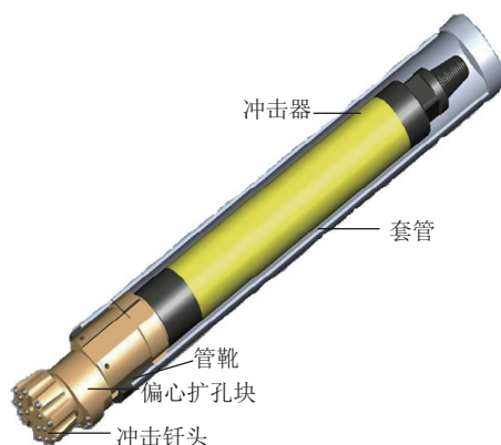
图 4 空气潜孔锤 (DTH) 偏心跟管钻具示意
