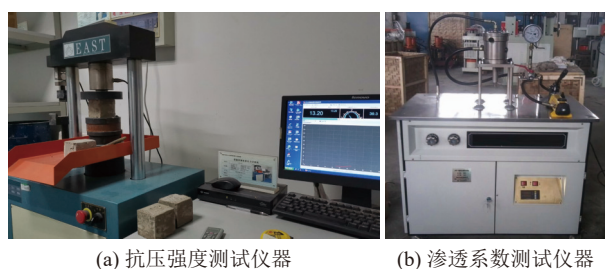
图 6 等厚度水泥土试样测试仪器
