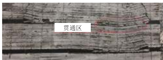
图 18 上下煤层覆岩贯通区结构模型
