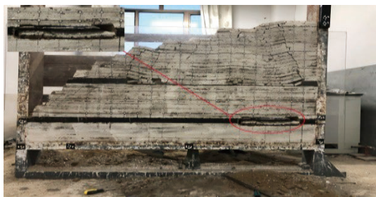
图 16 下煤层开采顶板岩体结构模型
