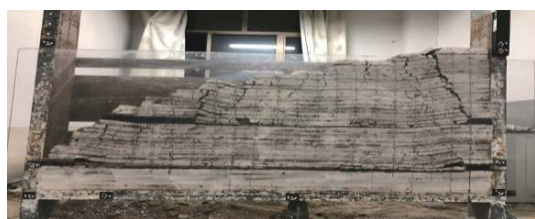
图 19 边坡变形破坏结构模型
