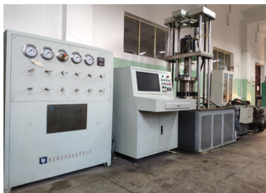
图 1 WYS-800 三轴瓦斯渗流试验装置
