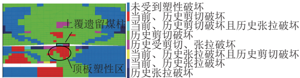
图 6 工作面进入遗留煤柱区时塑性区分布特征
